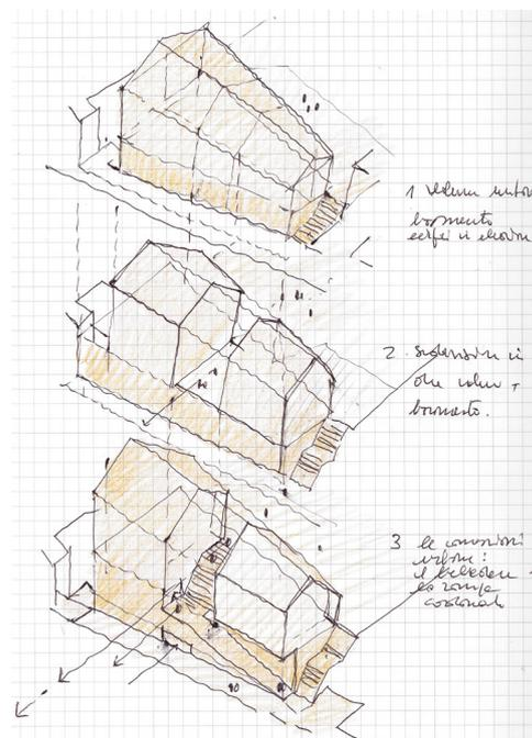
Fig. 7. Concezione progettuale: da un volume unitario a due volumi distinti. L'operazione di svuotamento genera il sistema di connessione pubblica: una piazza belvedere e una rampa - cordonata pubblica
