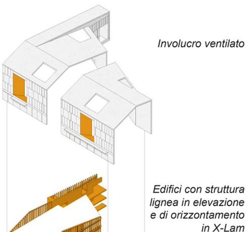
**Edifici con struttura lignea in elevazione e di orizzontamento in X-Lam**
