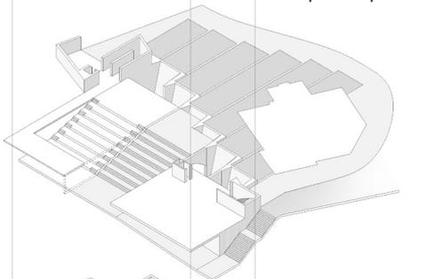
**Basamento con struttura in cls armato**
