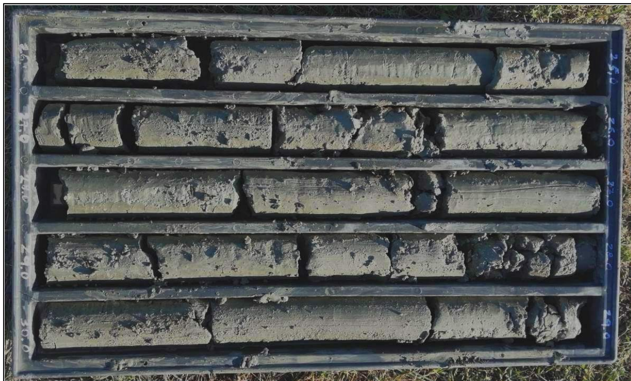
Foto n.°8: S1 cassetta n°6 (da 25,00 a 30,00 m)
