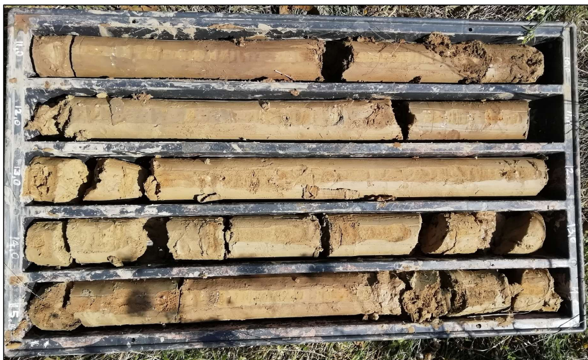
Foto n.°5: S1 cassetta n°3 (da 10,00 a 15,00 m)
